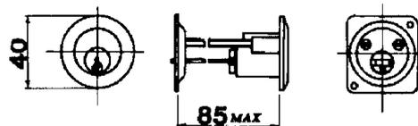
Габаритные размеры накладных электромеханических замков ISEO моделей 5213-, 5211-, 5111-, 5113-, аналогичны.
